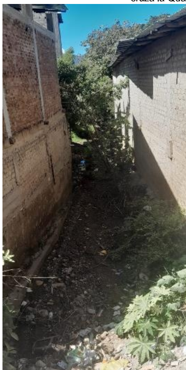
Fig. 03 Cauce Qda Chulucanas. Tramo crítico. Nótese canal de regadío que cruza la Qda y nótese la acumulación de sedimentos
